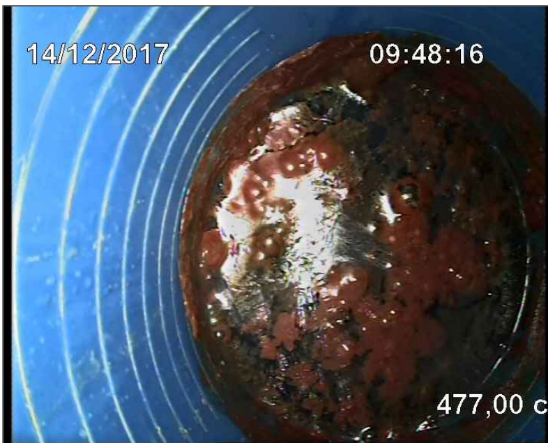
FOTO 07: Videoispezione PZ7. Evidenzia inquinanti alla quota -4.03 da superficie asfaltata, tipologia OLEOSI.
